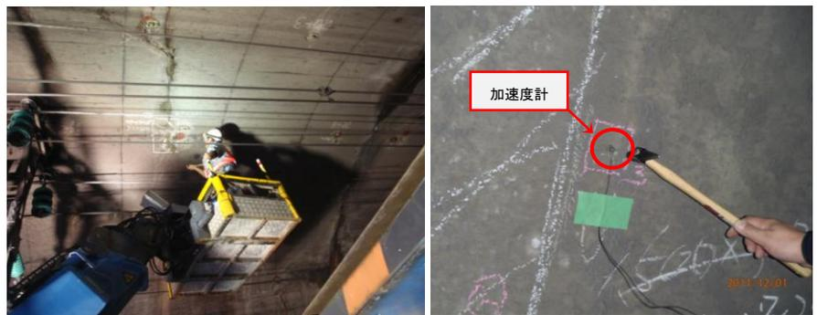
図 3 コンクリート表面加振試験実施状況
