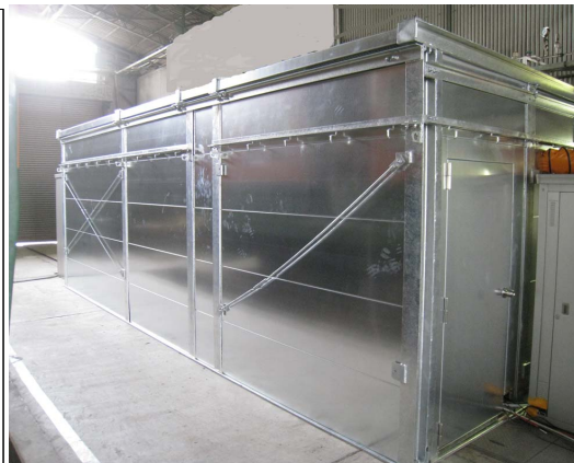
図5 防音室で遮音した試験装置
