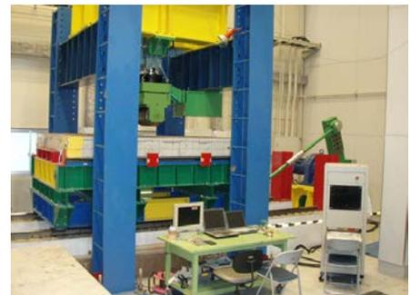
写真-1 架台移動式輪荷重走行試験機
