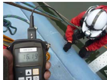
写真－5 管厚測定状況
