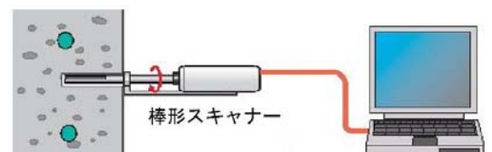
図-5 棒形スキャナーによる調査の概要
