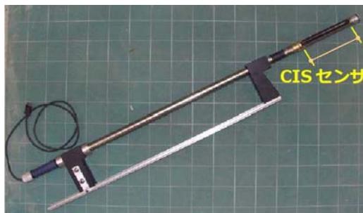
写真-3 羽田点検用棒形スキャナー
