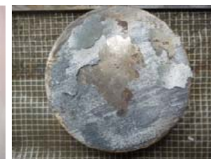
図 10 case5'塗膜除去後
