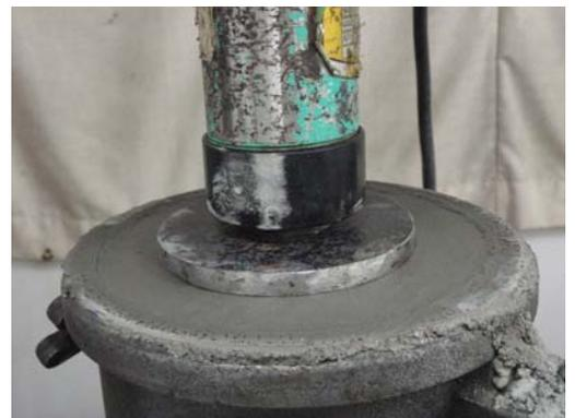
写真-2 荷重開始材齢 7.5hr 荷重面の状況
