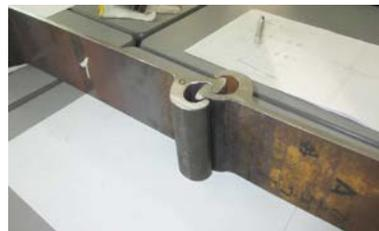
図-1 切り出した直線鋼矢板
