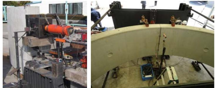
図-7 引抜き試験状況
