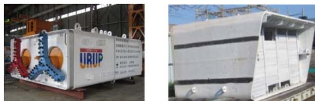
写真-1 シールドマシン(左:密閉型, 右:開放型前胴部)
