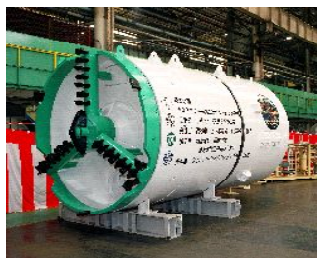
写真-3 シールド掘進機
