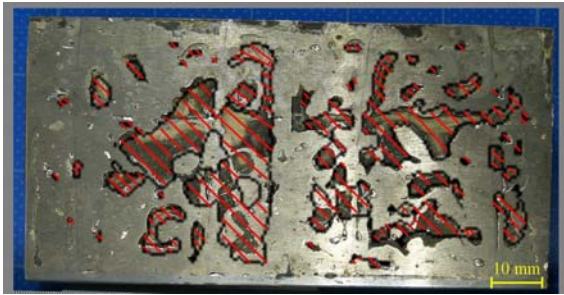
写真－2 ろう付面削り出し状況
