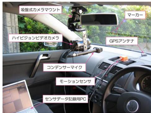
図-2 測定機材配置図
