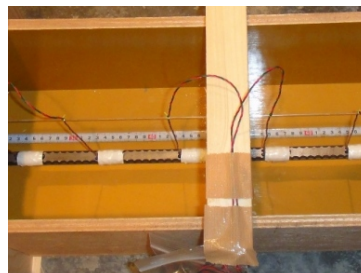
図-3 ひずみゲージ貼付状況
