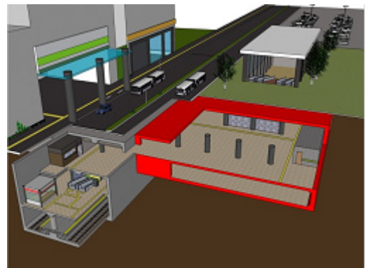
図-1 地下拡幅工事のイメージ
