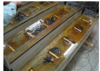
図-4 電食試験状況
