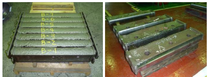
写真-4 ローラー部品（ブラスト後と一次加工後）
