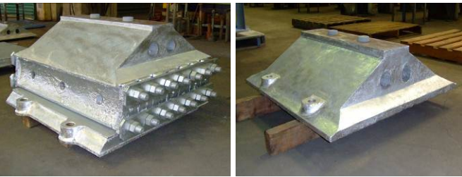
写真-5 可動・固定支承（再組立て後）
