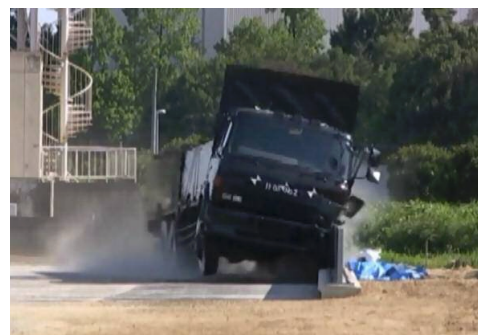
図-3 大型車衝突状況
