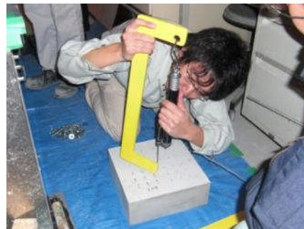
写真6 バネばかり簡易支圧試験
