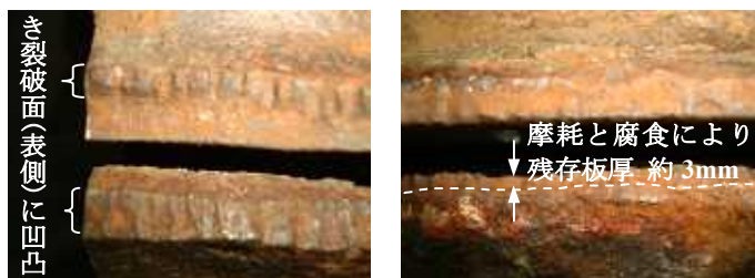
写真3 山形鋼切断面(き裂先端付近)
