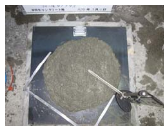
写真-3 中流動コンクリート
