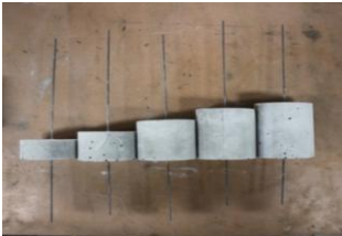
写真-2 片引き試験の供試体
