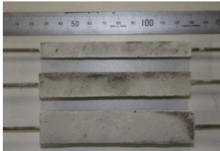
写真-3 両引き試験の供試体
