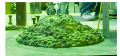
写真-1 s/a=42\% , フロー350mm
