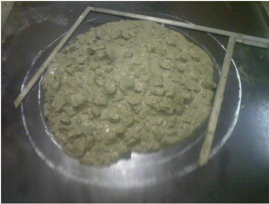
図-2 G40 のスランプフロー試験状況
