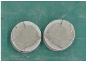
写真-1 割裂試験体
