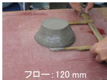
図-6 可塑化後の物性試験
