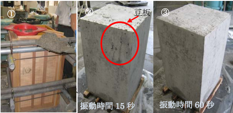
図－1 試験体の型枠および試験体の表面状況
