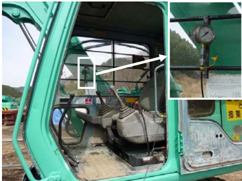
写真-1 油圧計設置状況
