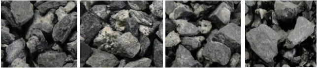
写真-2 バージン骨材と再生骨材
