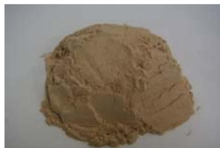
写真2 珪藻土 (Grain size under 0.050mm)
