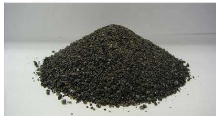
写真1 ゴミ溶融スラグ (Grain size under 2.36mm)
