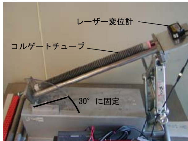
写真-1 長さ変化測定装置
