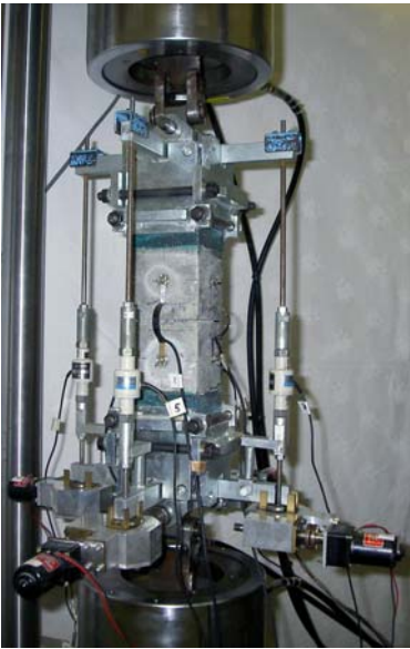
図-1 直接引張試験の状況
