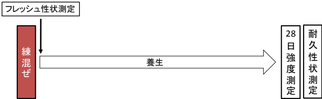
図 1 通常コンクリートの実験の流れ
