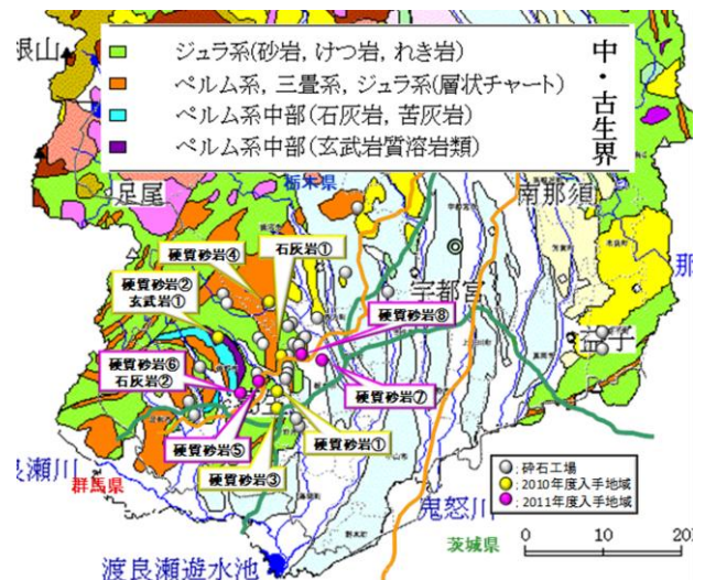
図-1 栃木県の碎石の採石・製造工場 3)
