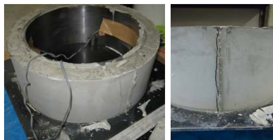
写真-1 ひび割れ発生状況
