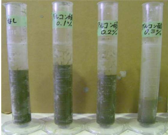
写真1 沈降試験の様子
