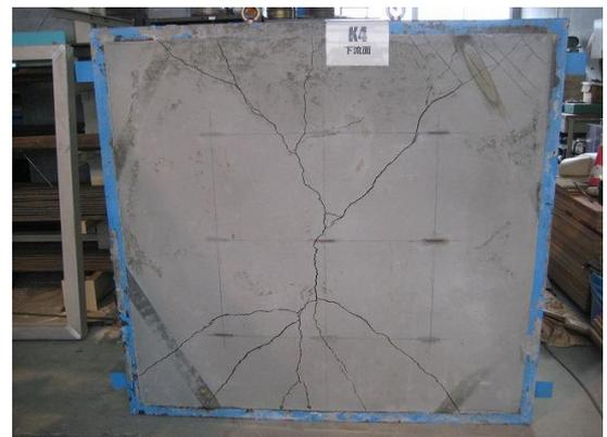
写真-1 実際のひび割れ状況 (K4 ゲート)
