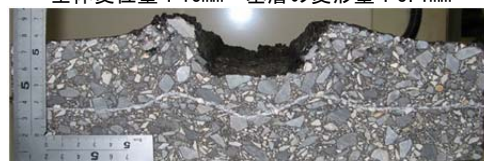
写真-1 わだち掘れ再現試験後供試体 (表層：密粒+基層：密粒)
