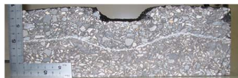
写真-2 わだち掘れ再現試験後供試体 (表層：密粒+基層：グース)
