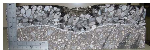
写真-3 わだち掘れ再現試験後供試体 (表層：ポーラス+基層：グース)
