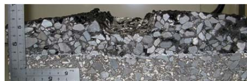
写真-2 わだち掘れ再現試験後供試体 (表層：ポーラス+基層：密粒)
