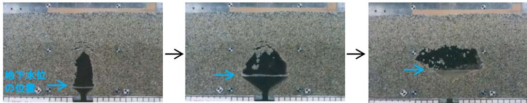
図-5 空洞の発達に関する既往の実験結果<sup>2)</sup>
