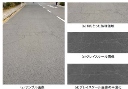
図-2 車載カメラを想定した画像の処理
