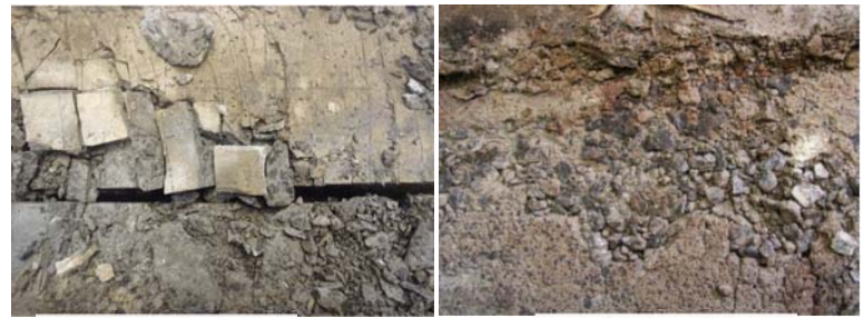
(a)軽量 Ex-w (b)普通-w 写真-1 供試体上面破壊状況
