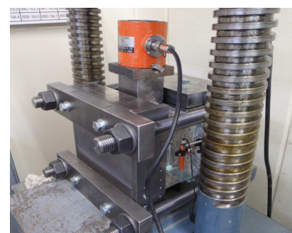
写真-7 押し抜きせん断試験状況
