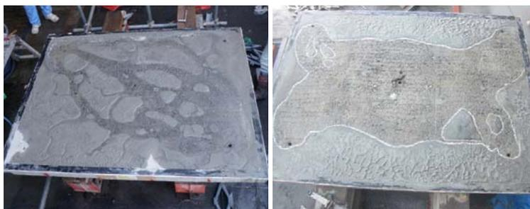
(a)ロータリーポンプの場合 (b)スピンジェットノズルの場合
