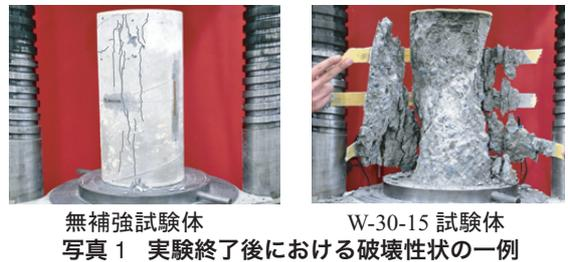
無補強試験体 W-30-15 試験体
