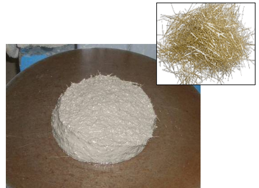
図-1 HPFRM のフロー試験(0 打, 122mm)
