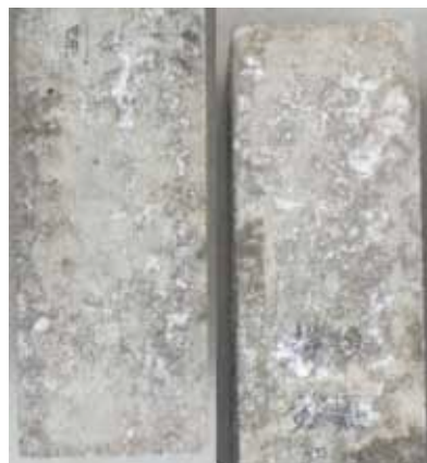
写真-1 乾燥湿潤環境の供試体底面の様子 写真-2 砂利化が起きた橋梁の底面の様子
