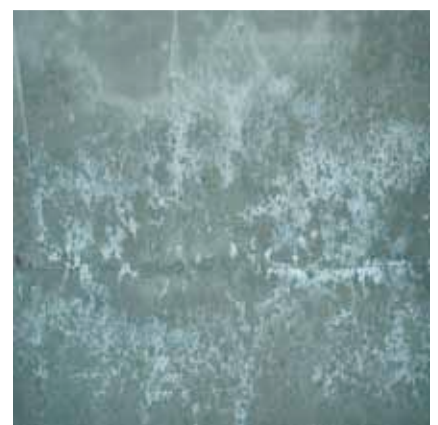
写真-1 乾燥湿潤環境の供試体底面の様子 写真-2 砂利化が起きた橋梁の底面の様子
