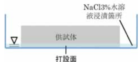
図-1 NaCl3%水溶液に浸した供試体の様子
