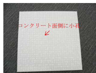
図-2 透水板の概要
