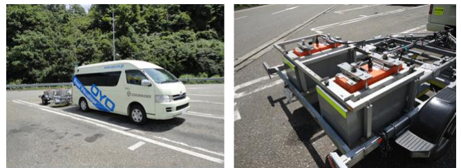
写真1 車載方式の計測に用いた路面下探査車とトレーラーに搭載した 2GHz アンテナ
