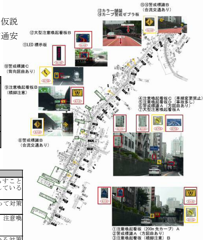
図-1 対象箇所の交通安全施設の配置状況
