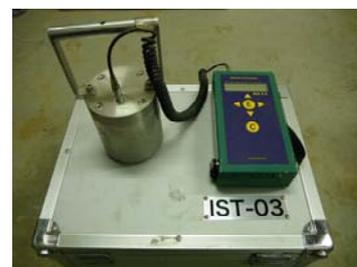
写真-1.超小型動的平板載荷試験装置
