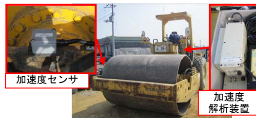
写真-1 転圧機械とαシステム
