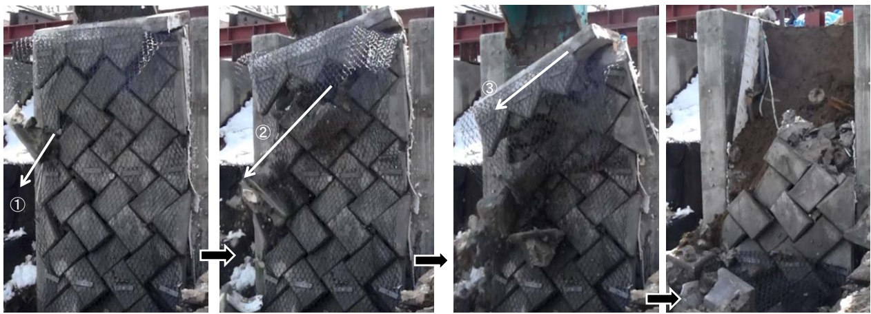
図4 ステップ6 載荷時における模型の崩壊状況
