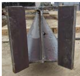
Photo 1 試験杭先端形状
